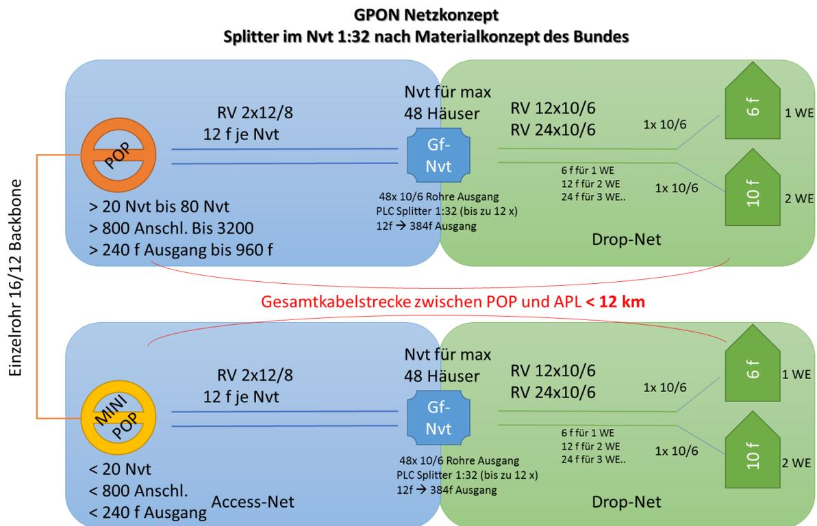
Bei der Netzplanung durch den GU muss ein diskriminierungsfreier Zugang für mehrere Anbieter möglich sein. Dies ist über hinreichende Dimensionierung der Leerrohre und Verteilpunkte sicherzustellen. Eine passive Kollokation ist einzuplanen und der Zugang zum Kollokationsstandort ist diskriminierungsfrei für Nachfrager von Vorleistungsprodukten zu ermöglichen.
